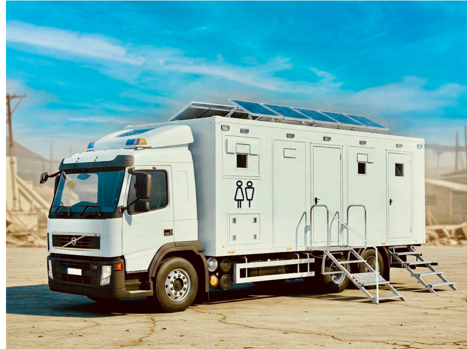
中型トラックの荷台に完全循環トイレを搭載
